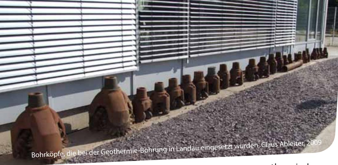
Bohrköpfe, die bei der Geothermie-Bohrung in Landau eingesetzt wurden, Claus Ableiter, 2009
